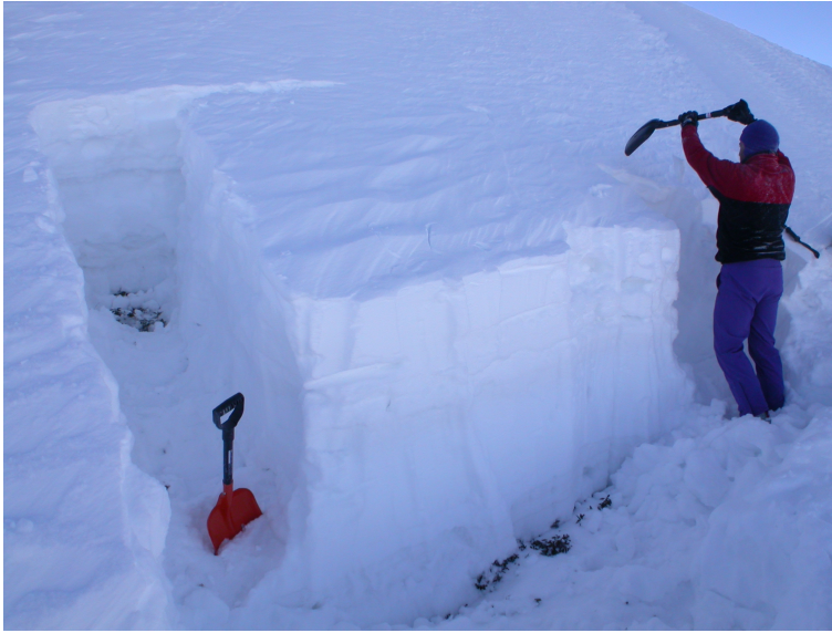
Figura 4.1: Operazione di isolamento del blocco di slittamento (foto L. Cavanna, ARPA Piemonte).
