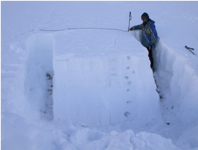
Figura 4.2: Operazione di taglio del blocco nel lato a monte con il cordino (foto E. Testa, ARPA Piemonte).
